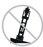
Überprüfen Sie, ob die Maschine waagerecht steht, und verlassen Sie sich nicht auf den Neigungsalarm. Der Neigungsalarm am Fahrgestell ertönt, wenn die Maschine auf abschüssigem Gelände steht.
