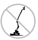
Der Ausleger darf nur angehoben oder ausgefahren werden, wenn die Maschine auf festem, ebenem und horizontalem Untergrund steht.
