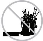
Verwenden Sie keine Leitern oder Gerüste auf der Plattform, und stützen Sie Leitern oder Gerüste nicht an der Maschine ab.
