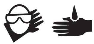
Verschütten Sie keine Batteriesäure, und vermeiden Sie den Kontakt damit. Verschüttete Batteriesäure ist mit Wasser und Lauge (doppelkohlensaures Natron) zu neutralisieren.
