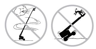
Das Fahren mit der Maschine über unebenes Gelände, Schutt, instabilen oder rutschigen Untergrund sowie in der Nähe von Bodenlöchern und abschüssigem Terrain darf nur bei eingefahrener Plattform unter Anwendung äußerster Vorsicht und mit langsamer Geschwindigkeit erfolgen.
