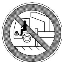
⇒ Im ausgehobenen Zustand muß das Fahrerhaus leer sein und lastfrei bleiben. D. h. bei ausgehobener Vorderachse ist der Aufenthalt im Fahrerhaus verboten! Zuladungen im Fahrerhaus bzw. zusätzliche Lasten oder Anbauten am Fahrerhaus sind ebenfalls verboten! Vordere Auftritte dürfen nicht benutzt werden!
