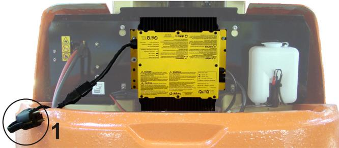
2. Beim ersten Einschalten führt das Ladegerät einen kurzen Selbsttest der LED-Anzeige durch. Die Leuchte des Batterieladegeräts am Bodensteuerpult leuchtet mehrfach hintereinander zwei Sekunden lang auf.
