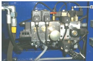
Bitte vergessen Sie nicht nach beendetem Notablaß die Notablaßventile wieder zu schließen (1 nach rechts drehen bis er einrastet).
