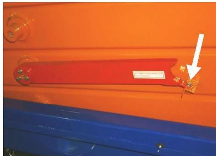
**Diese Abstützung ist unbedingt zu verwenden bei Arbeiten in der Nähe der Scheren, sofern die Plattform angehoben ist.**
