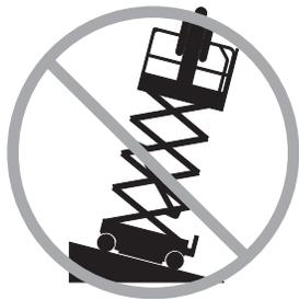
Achten Sie beim Anheben der Plattform stets darauf, dass sich die Maschine auf einem festen, ebenen und horizontalen Untergrund befindet.
