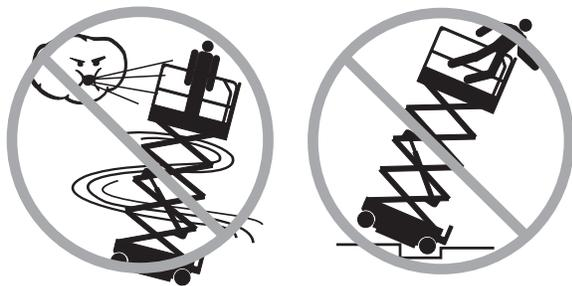
Fahren Sie bei angehobener Plattform mit der Maschine nicht auf unebenem Gelände, instabilem Untergrund oder in sonstigen Gefahrensituationen.
