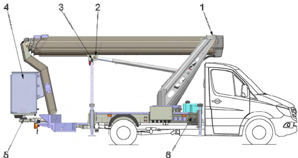
Der Ruthmann-Steiger TBR 250 wird durch zwei voneinander unabhängige, in Reihe geschaltete Isolierstrecken gegen Erde isoliert.
