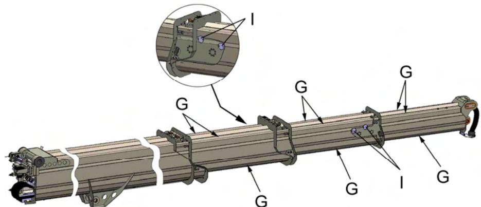
Das Teleskop zum Abschmieren (Fetten) so weit wie möglich ausfahren und die Gleitflächen („G“) dünn, z. B. mit Hilfe eines Heizkörperpinsels einfetten.
