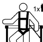
⇒ Nur für Rückhaltesysteme. Anschlagpunkt (Halteöse) für ein Rückhaltesystem gegen Absturz. In diesem Beispiel eine Person je Anschlagpunkt.
