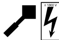
⇒ Isolation bis AC 1000 V (max. 60 Hz) und DC 1500 V nach DIN VDE 0682-742. Sie erlaubt den Einsatz an oder in der Nähe von unter o. g. Spannung stehenden Teilen elektrischer Anlagen. (**ACHTUNG: Nur bei Anbau einer geprüften, elektrisch isolierten bzw. isoliert angebrachten, typisierten Ruthmann-Arbeitsbühne!**)
