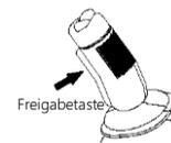
Drücken Sie nicht die Freigabetaste am Steuerhebel. Drücken Sie den Steuerhebel nach vorn und hinten. Vergewissern Sie sich, dass keine Verfah- und Hebefunktionen mehr funktionieren.
